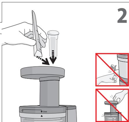
きれいに洗った材料を少しずつ投入口に入れ、押し棒で押します。
