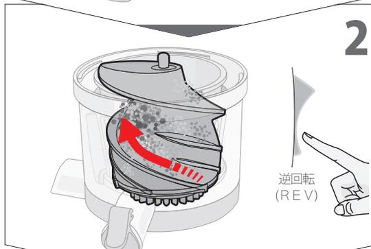
作動スイッチの[逆回転(REV)]ボタンを3～5秒間押し放す過程を2～3回繰り返して、詰まった食材を上部へ動かして下さい。
